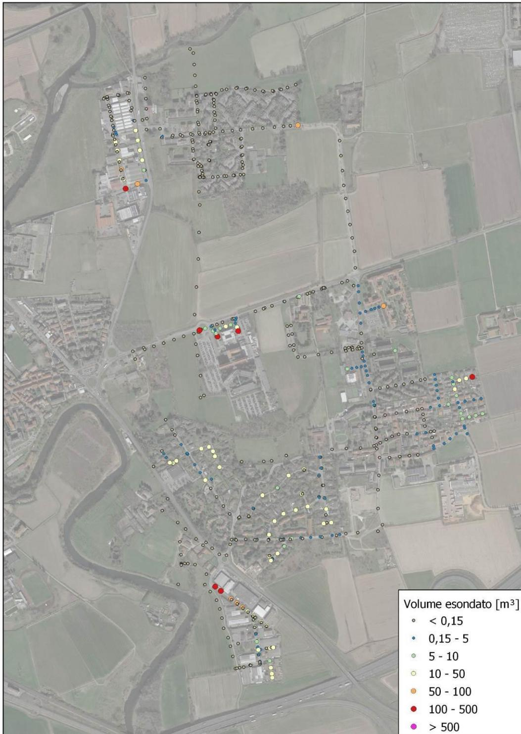
*Figura 68 - Risultati dello stato di progetto – Esondazione nodi per Tr50 anni*
