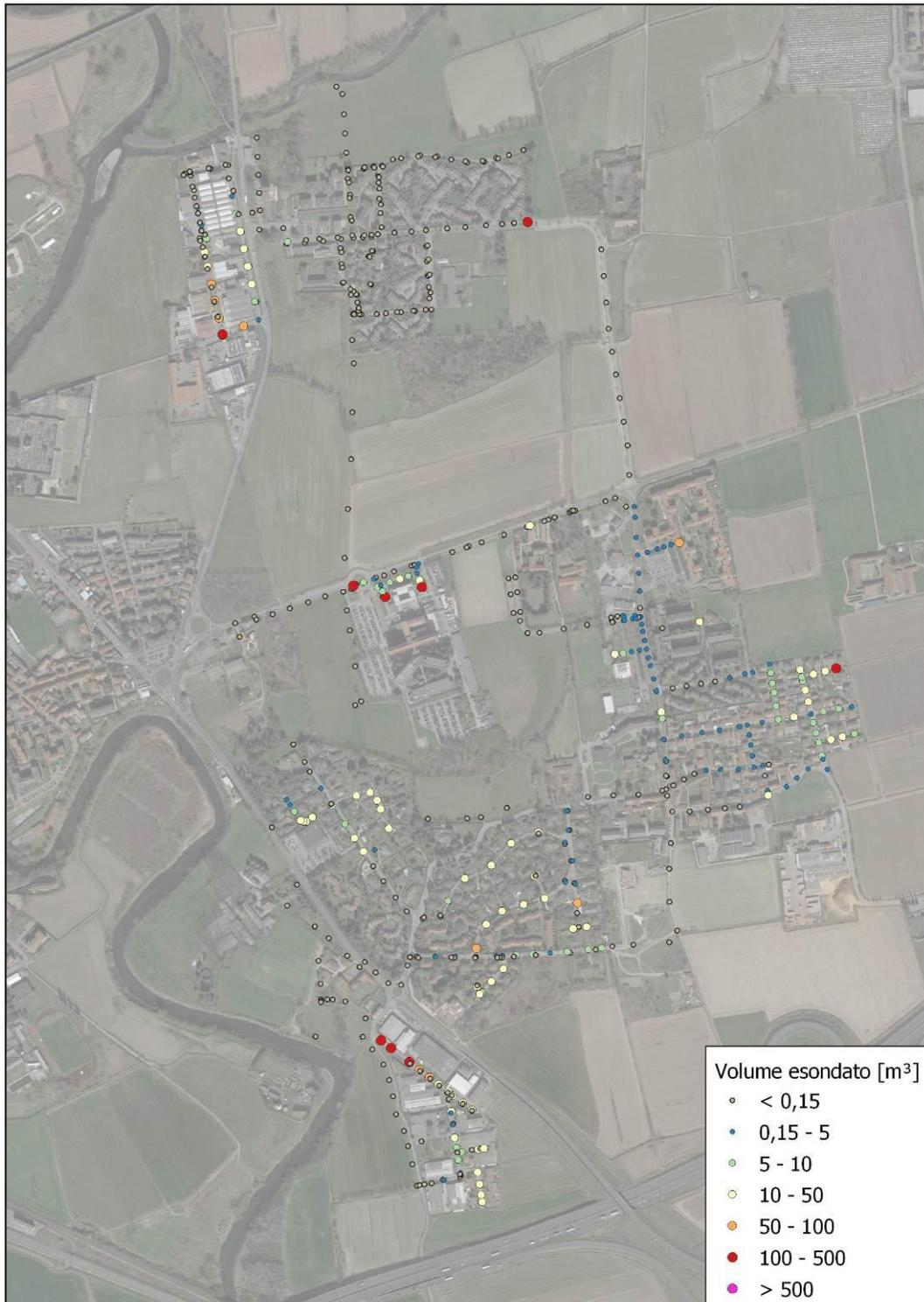
**Figura 29 - Risultati dello stato di fatto – Esondazione nodi per Tr100 anni**
