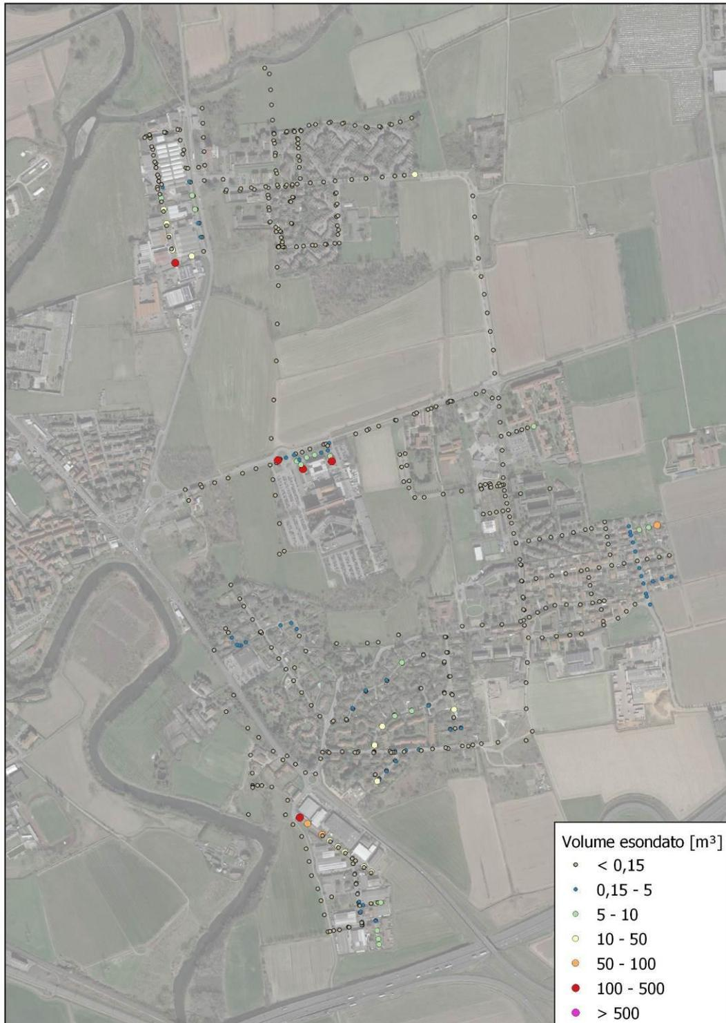
*Figura 25 - Risultati dello stato di fatto – Esondazione nodi per Tr10 anni*
