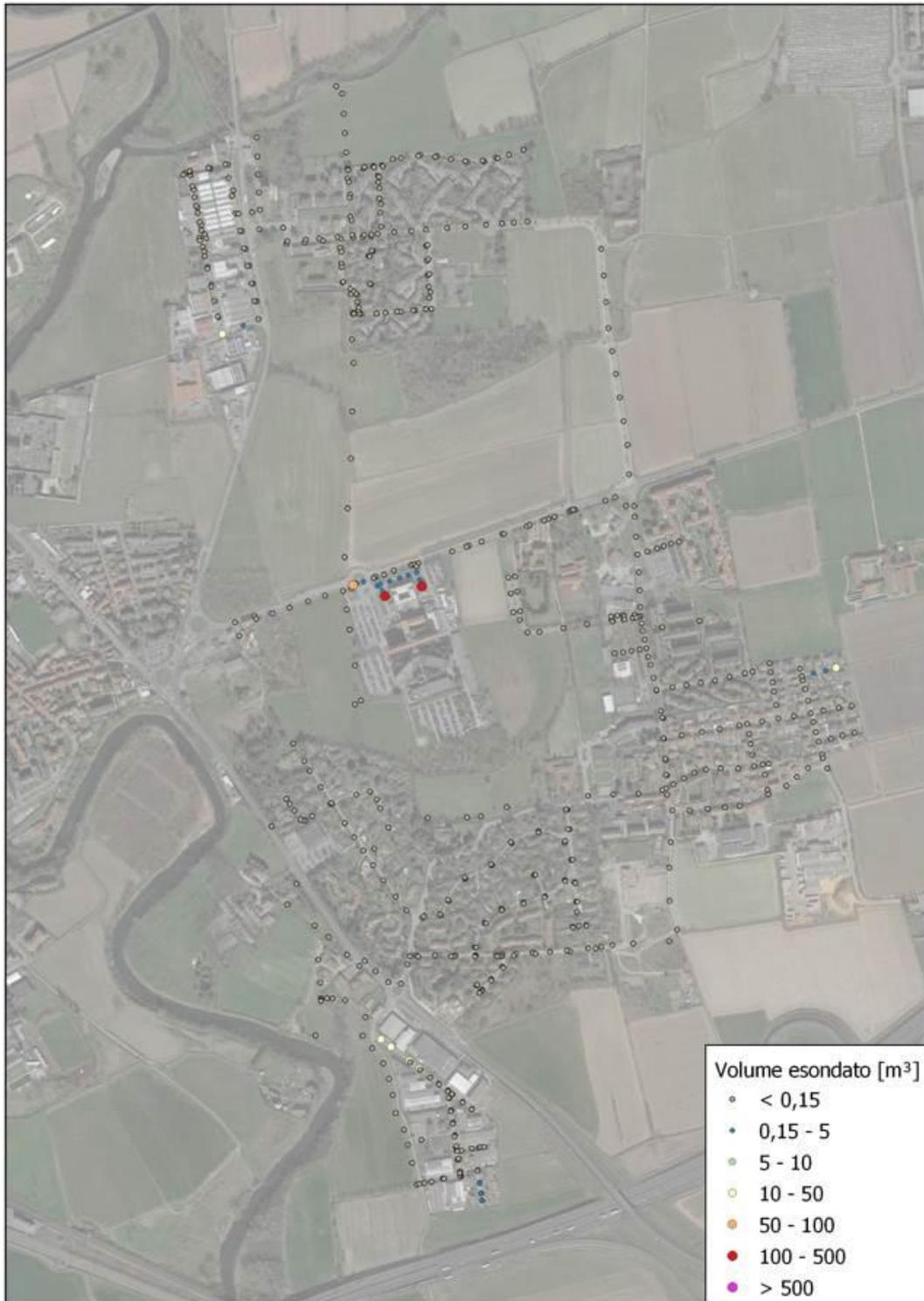
*Figura 23 - Risultati dello stato di fatto – Esondazione nodi per Tr2 anni*
