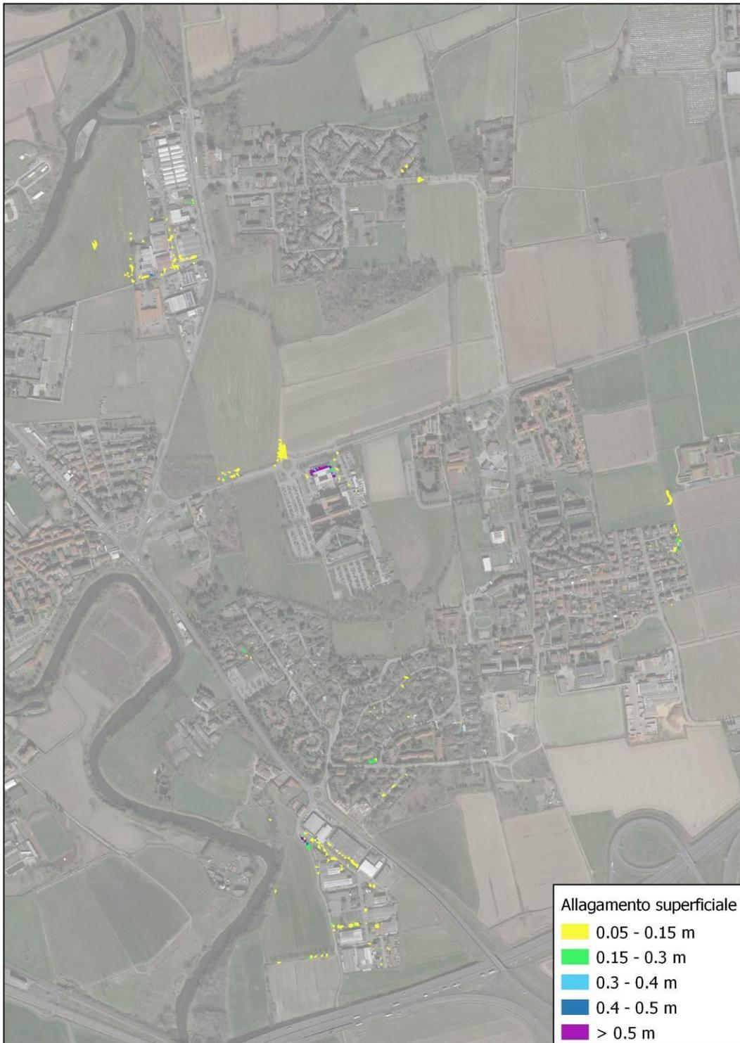
*Figura 73 - Allagamento allo stato di progetto con TR 10 anni*
