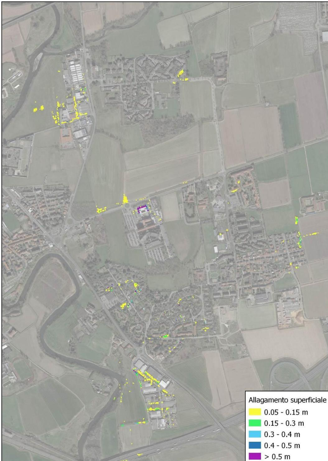
*Figura 74 - Allagamento allo stato di progetto con TR 50 anni*
