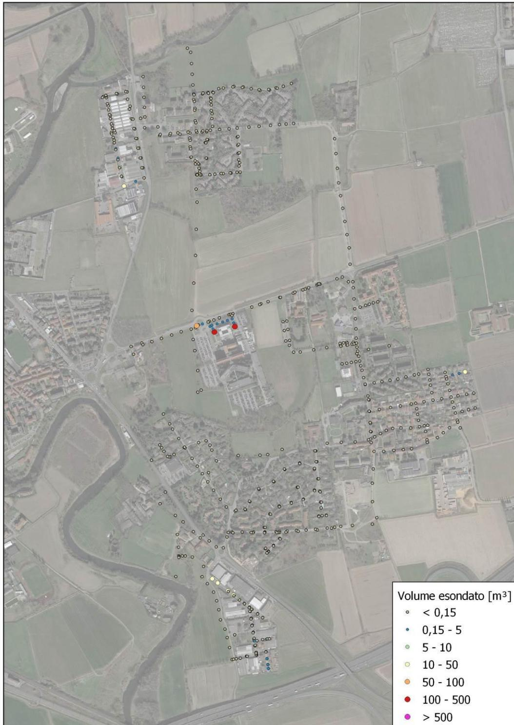
*Figura 64 - Risultati dello stato di progetto – Esondazione nodi per Tr2 anni*
