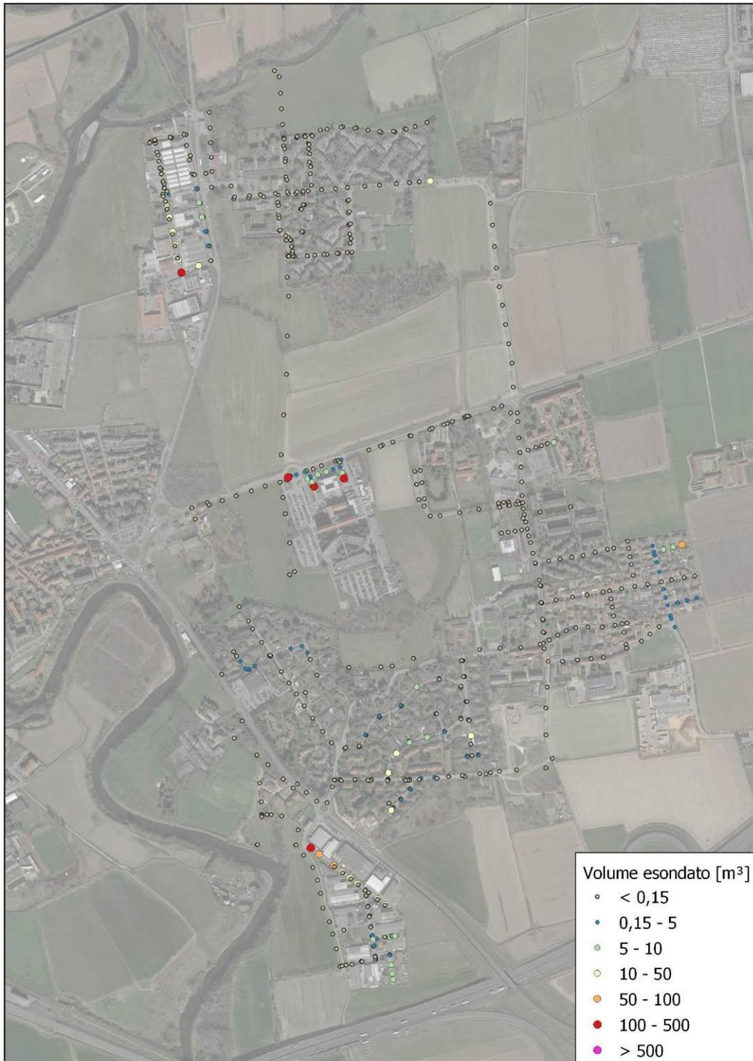
*Figura 66 - Risultati dello stato di progetto – Esondazione nodi per Tr10 anni*
