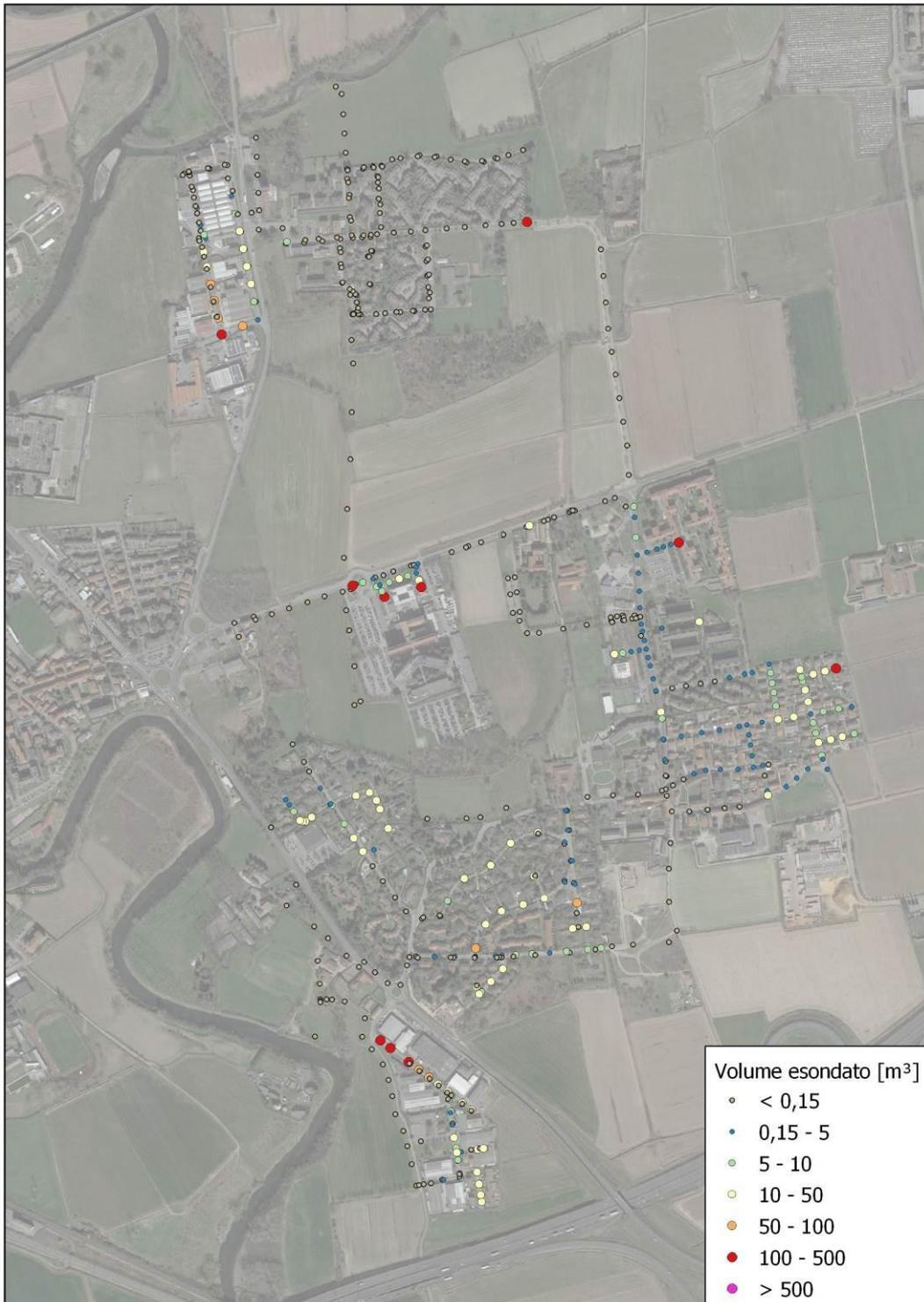
**Figura 70 - Risultati dello stato di progetto – Esondazione nodi per Tr100 anni**
