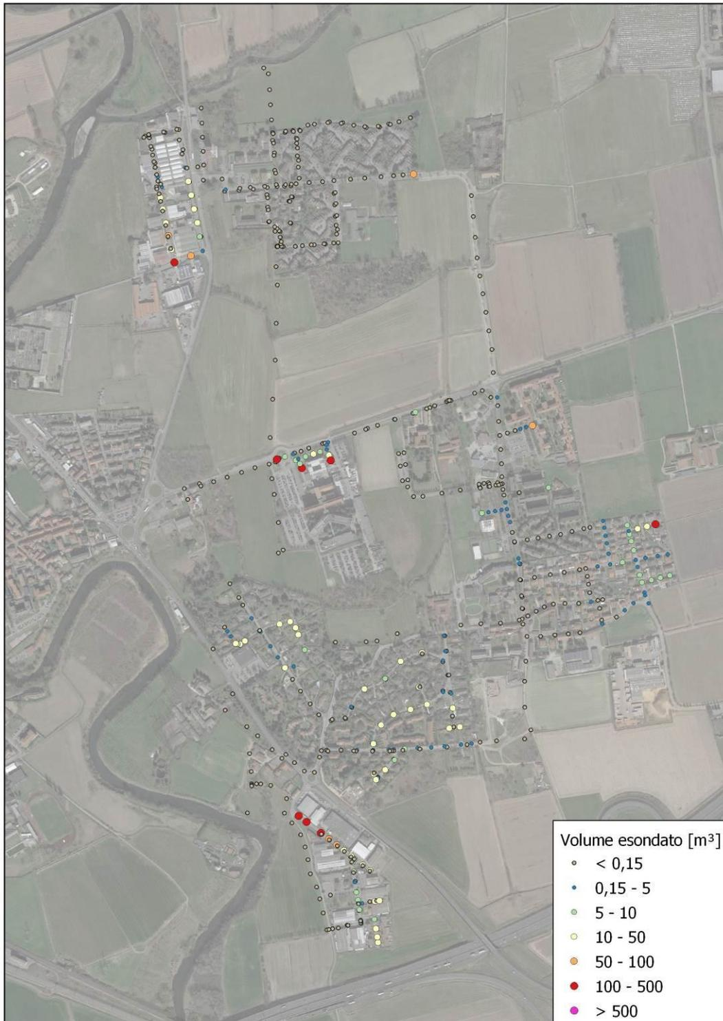
*Figura 27 - Risultati dello stato di fatto – Esondazione nodi per Tr50 anni*
