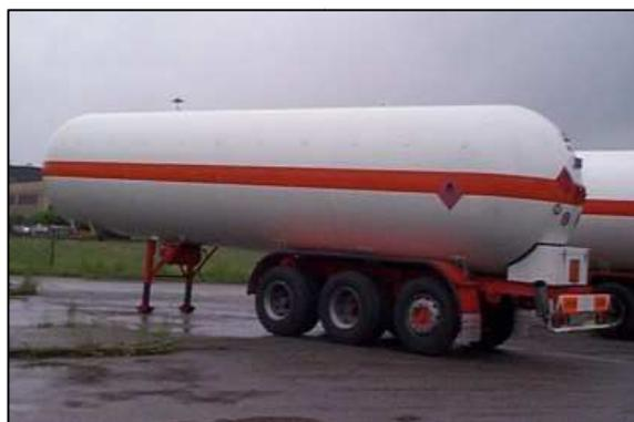
*Figura 5.11: sezione cilindrica con calotte semisferiche*
